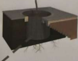
Lámina antirraíces: RootBarrier® RollRib®
