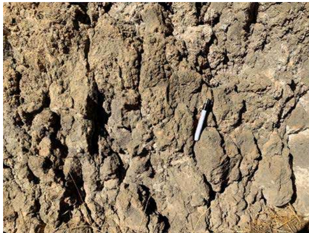
Figura 23. Punto de observación 4. Detalle de la estructura interna de la facies caótica. Fuente: CRS Ingeniería.
