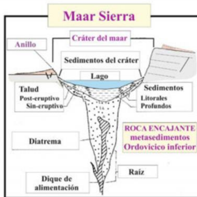
Figura 4.5.- Esquema de maar tipo sierra.
